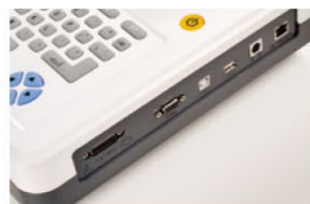
Memória para 300 registros de ECG; USB para transmissão de dados; Suporte a software de ECG em PC; Suporte à conexão de impressora externa
